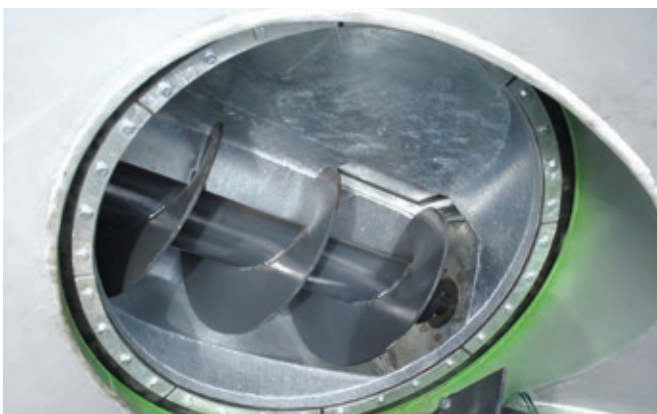
Förderschnecke Durchmesser 500 mm
